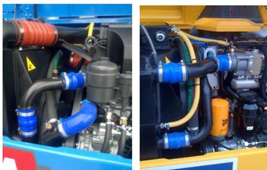
Manicotti diritti o sagomati a mandrino per settore automotive, camion, macchine movimento terra, etc. per passaggio di aria o liquidi refrigeranti.
